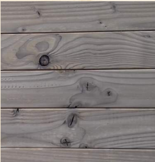
Photos illustrant du Douglas français T.H.T., avec un fort taux de rebus.
