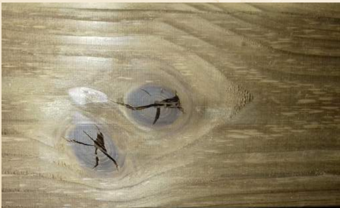
Photos illustrant du Douglas français T.H.T., avec un fort taux de rebus.
